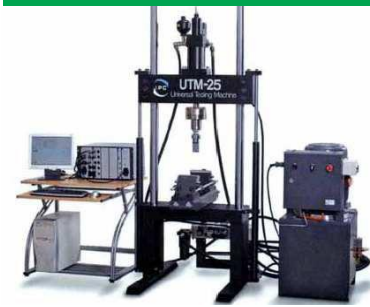
Sistema di prova servo-idraulico da 25 kN
