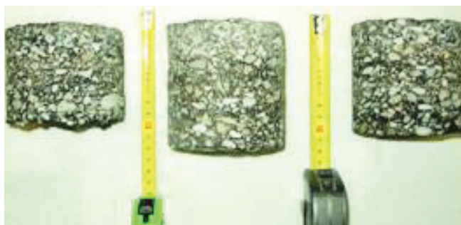
Fig. 2 Campioni prelevati tramite carotaggio
